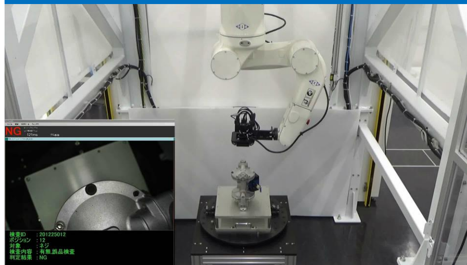
To : ロボット統合コントローラによる制御
